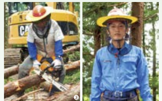
① 阿部竜一さんと佐藤勝彦さん ② 夏のユニフォームはヘルメット(この日は雨除け帽も)、蜂網(フェイスガード兼)、蜂専用手袋、チャップス、鉄板の入った脚絆、地下足袋、安全長靴。全て会社から支給されている。「地下足袋は雨の日は2足持つていく。一流の職人はカッコいい。一流の防具を用います」と阿部社長 ③ 伐倒した木の枝払いをする佐藤さん
